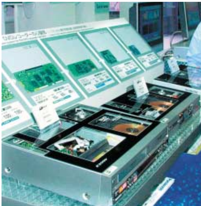
Sichtbarer Fortschritt: Bei Panasonic wird gezeigt, wie die immer höhere Integration der Bauteile die Platinen von DVD-Video-recordern vereinfacht und verkleinert hat. Heute gibt es schon die fünfte Generation
