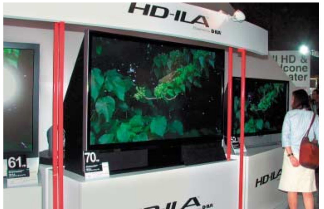
JVC setzt seine D-ILA Projektionstechnik jetzt auch für Rückprojektoren von 52 bis 70 Zoll Bildschirm-diagonale ein. Mit 4,5 Millionen Bildpunkten wird ein hervorragendes High-Definition Bild erreicht
