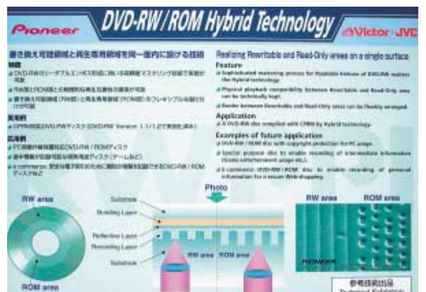
Hier das Funktionsprinzip der von JVC und Pioneer entwickelten Kombination von DVD-ROM und DVD-RW. Neue Mastering-Techniken haben es möglich gemacht, die vollkommen verschiedenen Pit-Strukturen für die fixen und die variablen Informationen auf ein- und derselben Disc zu realisieren
